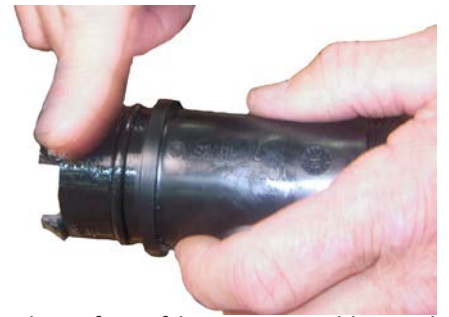
11) Schmierfett auf den neuen Anschluss und seine Dichtung sowie auf die Auflagefläche des Anschlusses am Kondensator auftragen.
