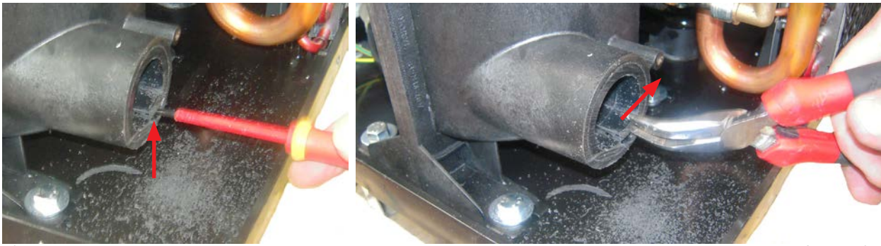
8) Das kleine ausgeschnittene Stück anheben und mit einem Schraubendreher und einer Zange entfernen ( darauf achten, die Auflagefläche des Anschlusses am Gehäuse des Kondensators nicht zu beschädigen ).
