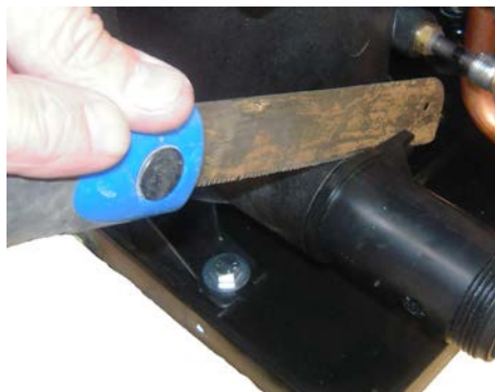
6) Den Anschluss an der Basis des Kondensators schneiden (darauf achten, den Kondensator nicht zu beschädigen).
