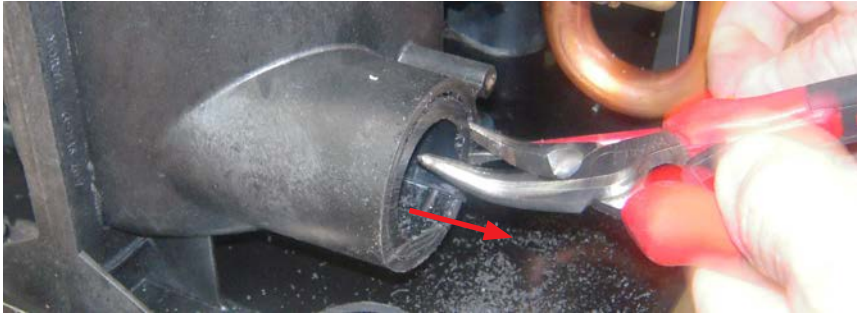
9) Den restlichen Anschluss mit einem Schraubendreher anheben und mit einem Schraubendreher und einer Zange entfernen.
