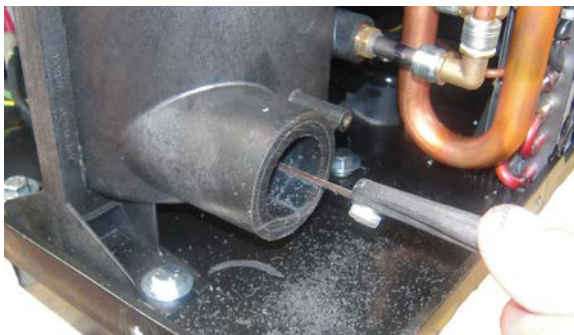
7) Die Befestigungslaschen des Anschlusses im Inneren des Kondensators orten und einen Schnitt zwischen 2 Laschen ausführen. Darauf achten, das Gehäuse des Kondensators und den Bereich der Auflagefläche der Anschlussdichtung nicht zu beschädigen (im Abstand von 5-10 mm vom Kantenende des Kondensators)! Der O-Ring kann während dieses Vorgangs jedoch geschnitten werden, da ein neuer O-Ring mit dem Anschluss mitgeliefert wird.
