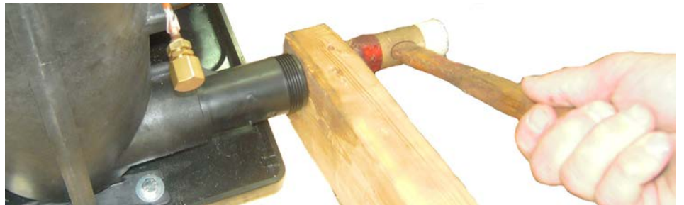
13) Den Anschluss mit einem Klotz und einem Holzhammer einschlagen ( darauf achten, den Kondensator zu halten , um zu vermeiden, dass die Füße des Kondensators durch die Schläge brechen).
