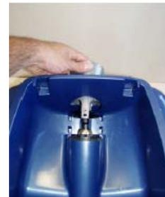
**5. Die Schraube des Pumpenmotors herausziehen**
