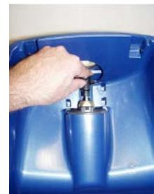
**6. Den Roboter umdrehen und die 4 Halteschrauben des Motorblocks entfernen**
