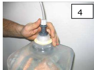
5. Angeschlossenen Behälter in die Konsole schieben. Es ist darauf zu achten, dass der Flanschring in der dafür vorgesehenen Führung sitzt.
