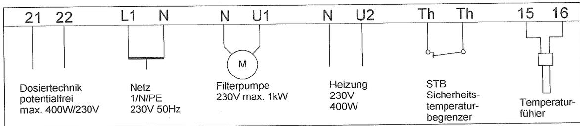
An die Klemmen U2 und N kann anstelle einer Zirkulationspumpe auch ein Zusatzschaltkasten für Heizung angeklemt werden. Mit Hilfe dieses Zusatzschaltkastens kann dann eine Elektroheizung direkt geschaltet werden. Es eignen sich die Zusatzschaltkästen 10,5 kW (Art. Nr.: 3002000100), 18 kW (Art. Nr.: 3002400100) und 30 kW (Art. Nr.: 3002100100)
