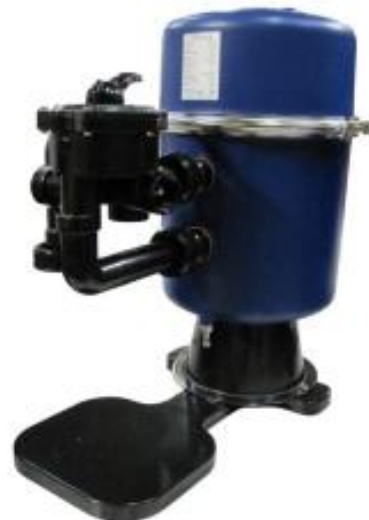
Filterkessel Serie FP mit Filterpalette und 6-Wege-Ventil
